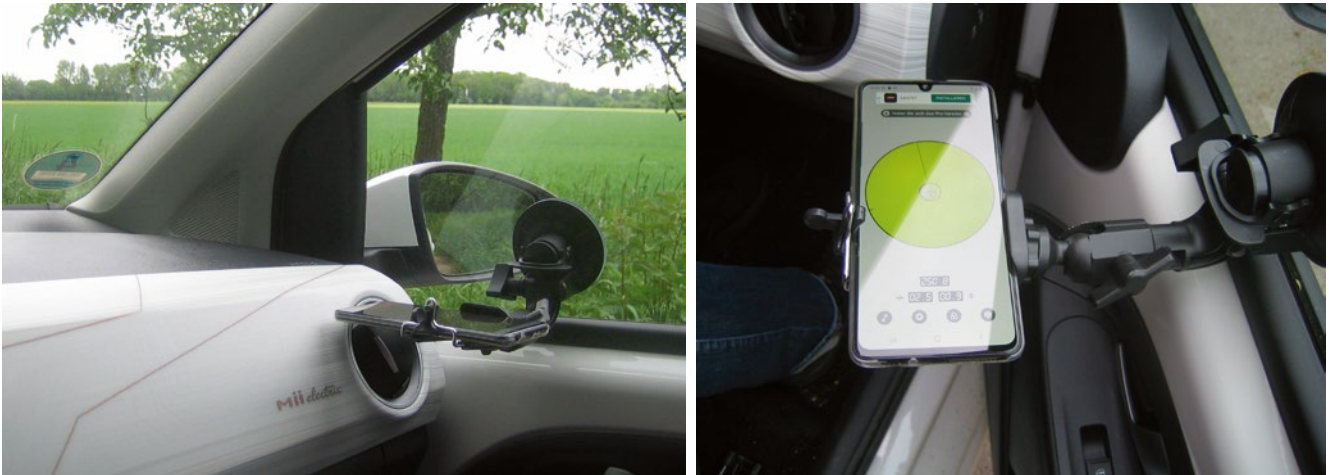
BILD 2 UND BILD 3: Das Smartphone wurde waagrecht an der Beifahrerscheibe montiert und in y-Richtung gemessen FIGURE 2 AND FIGURE 3: The smartphone was mounted horizontally on the passenger window and measured in the y-direction
